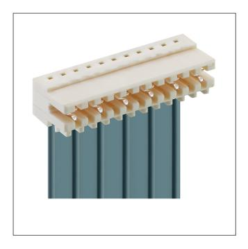
RAST-2.5-Steckverbinder für direktes und indirektes Stecken, in Schneidklemmtechnik (SKT), mit Innenverrastung, für Rasterstegleitung, teilungsgerecht anreihbar Kontaktraster 5,0 mm
